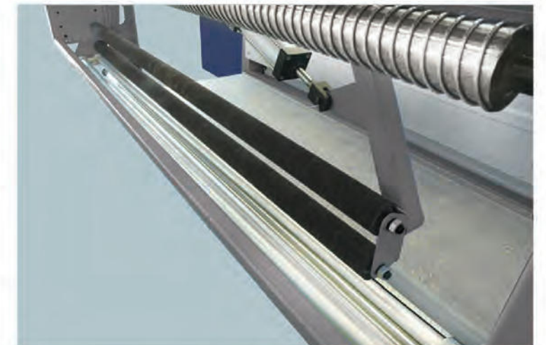
自动对中展布纠偏 Auto aligning expanding gear
