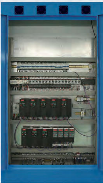
电子柜采用进口丹佛斯变频器。 西门子PLC Imported Danfoss inverter and Siemens PLC.
